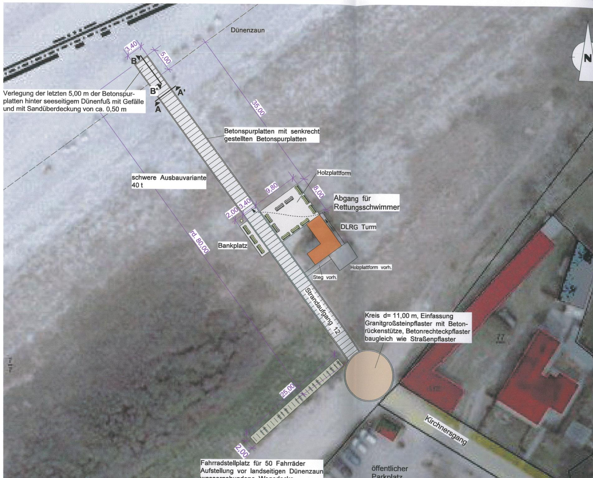
Verlegung der letzten 5,00 m der Betonspurplatten hinter seeseitigem Dünenfuß mit Gefälle und mit Sandüberdeckung von ca. 0,50 m
