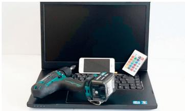
Immer mehr Elektrogeräte werden mit **Lithium-Batterien/-Ionen-Akkus** (Hochenergiebatterien) betrieben. Die Vorteile dieser modernen Batteriesysteme sind eine längere Lebensdauer sowie eine kaum wahrnehmbare Selbstentladung. Bei einer unsachgemäßen Entsorgung stellen sie jedoch aufgrund ihrer erheblichen Energiedichte eine hohe Brandgefahr dar. Aus diesem Grund ist es besonders wichtig, dass Batterien und Akkus am Ende ihrer Lebensdauer richtig entsorgt werden.
